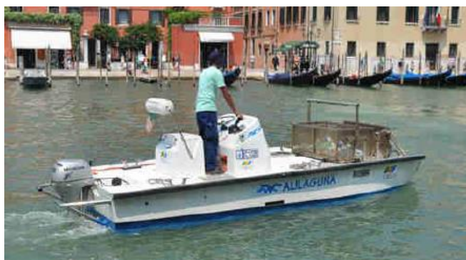
Figura 4-17: Catamarano Veritas per la raccolta dei rifiuti galleggianti
